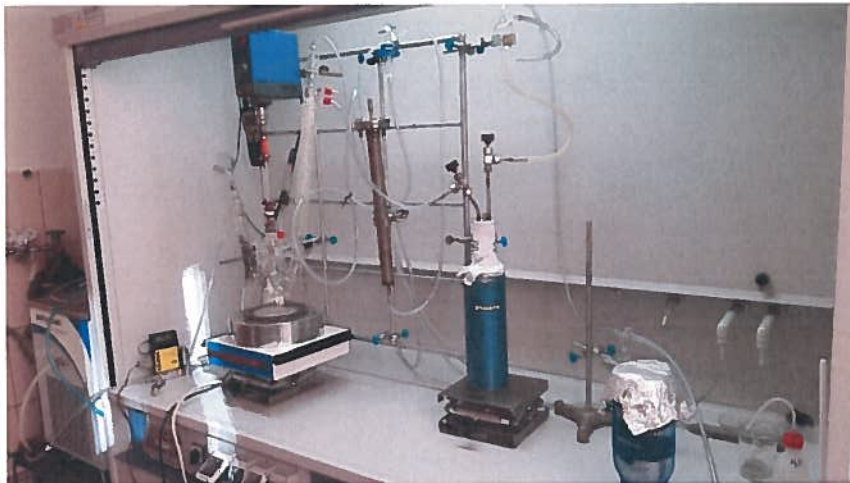
Figura 4. Instalația de laborator dedicată sintezei de ^{15}\text{NH}_3 .
