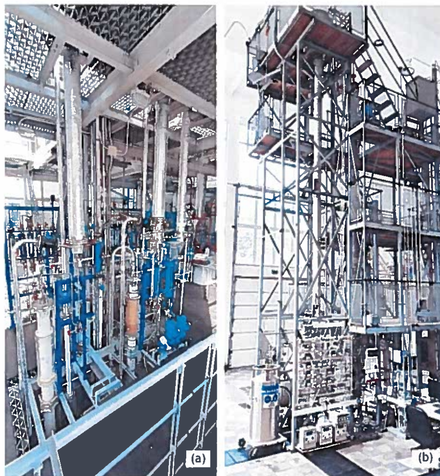
Figura 2. Instalația de cercetare tehnologică și producere a ^{15}\text{N} (a) și Instalația experimentală de separare a ^{13}\text{C} prin distilare criogenică (b).
