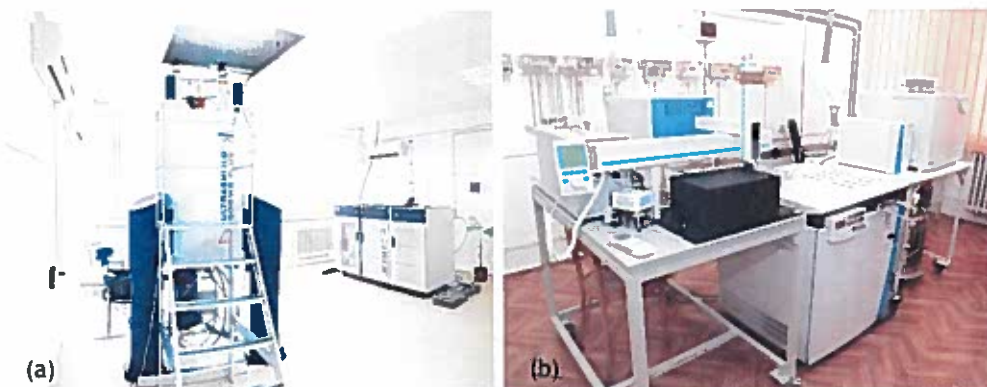
Figura 3. Spectrometrul RMN Bruker AVANCE III (a) și spectrometrul IRMS Delta V Advantage (b).
