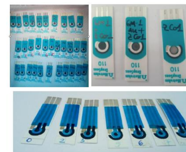
Figura 5. Imaginea optică a electrozilor electrochimici modificați cu grafene/zeolit-nanoparticule de cobalt
